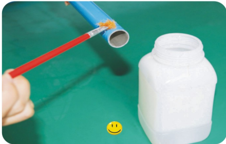
Comeback 铝管修毛刺，以免割伤密封圈。 ▲
